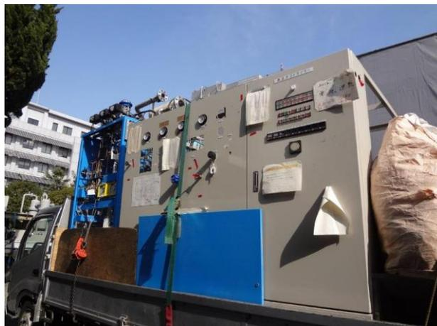
撤去されトラックに積まれた古いヘリウム液化装置（奥）と高圧ガスドライバー（手前）。
